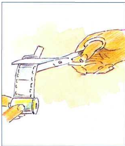
1. Отрежьте зарядный конец, чтобы получился прямой срез с закругленными углами.
