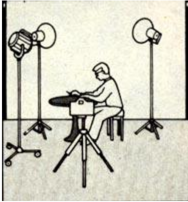
Рис. 77 Задний план был освещен двумя приборами заливающего света, образовавшими за моделью световое пятно. Позирующий облакачивался на круглый стол, и на его лицо был направлен луч маленького прожектора. «Пентакс» 6х7, 105мм, 1/30 с., диафрагма 11.
