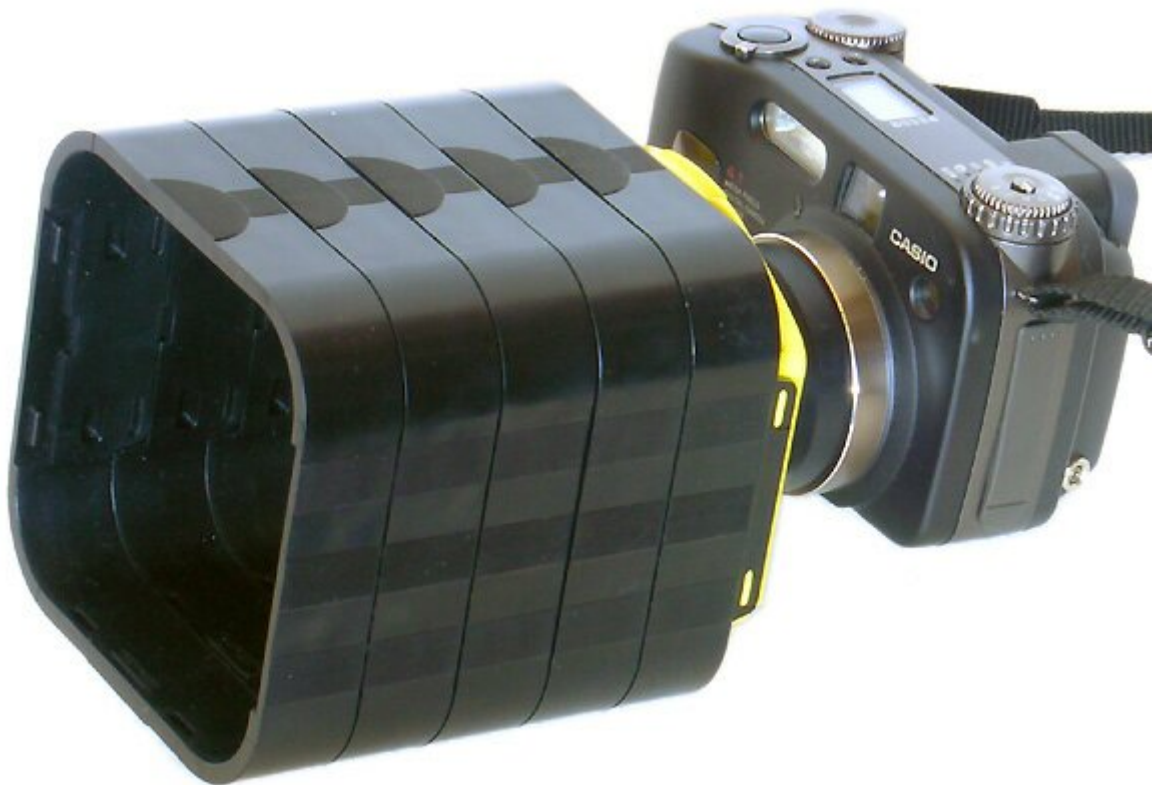
Камера Casio QV4000 с блендой из 5 секций для съемки с максимальным фокусным расстоянием. Правильное количество секций легко определить, повернув держатель на 45 градусов, в этом случае углы будут виньетироваться.
